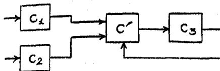
Пусть  $\{\lambda, a, b\}$  – выходной алфавит автомата  $C_1$ ,  $\{\lambda, a, c, d\}$  – выходной алфавит автомата  $C_2$ . Выходной алфавит автомата  $C_3$  содержит значение буквы, которые синхронизатор воспринимает как одну букву  $\epsilon$  и пустую букву  $\lambda$ .
