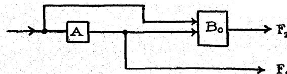
Каскадное соединение, автомат  $C_0$
