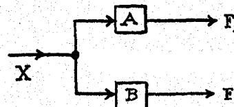
Параллельное соединение, автомат  $C$
