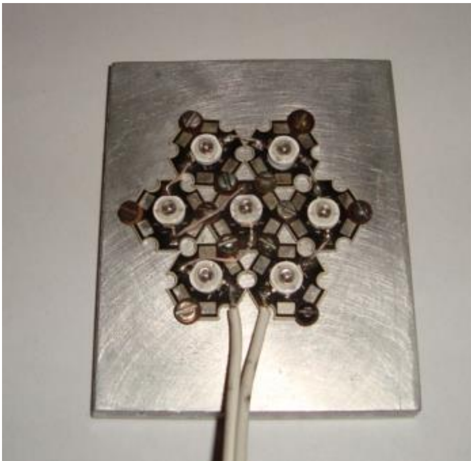
სურათი 49. 60 ვატი სიმძლავრის ინფრაწითელი გამანათებელი.
